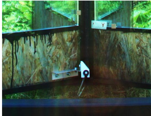
Abbildung 9: Photovoltaik-Sensor zur Messung der Strahlung hinter den Versuchsscheiben.
