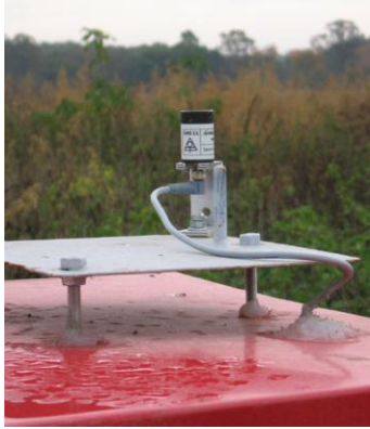
Abbildung 8: Photovoltaik-Sensor zur Messung der Globalstrahlung.
