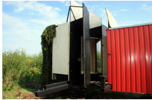
Abbildung 5: Blenden (schwarze Platten) schränken die Sicht des Vogels auf die Glasscheiben ein. Die Seitenwände (weiße Platte) und das Tarnnetz (grüner Vorhang) reduzieren die Lichtintensität im Tunnelhintergrund auf \leq 25\text{W/m}^2 .
