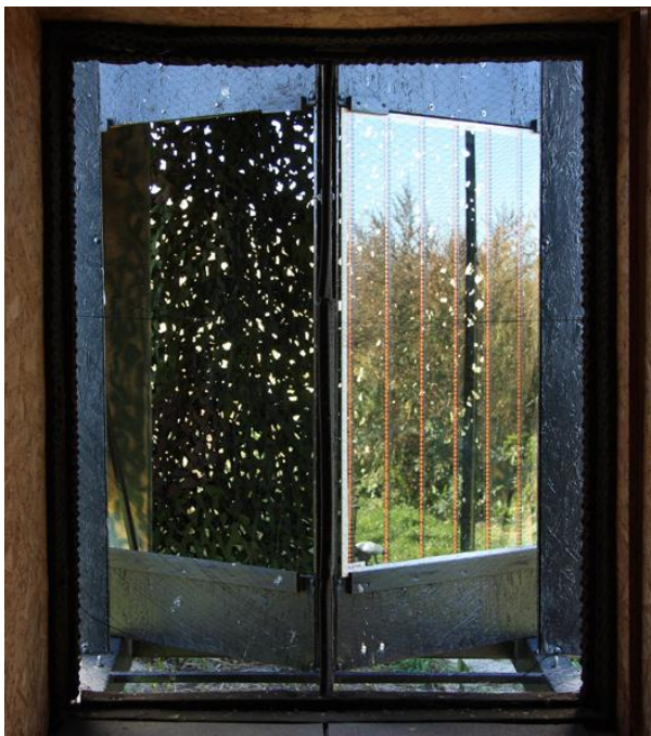
Abbildung 6: Tunnel-Ende mit Scheibenhaltung und abgedunkeltem Bereich im Hintergrund der Scheiben. Links: keine Scheibe, freie Sicht auf Tarnnetz (künstlicher Hintergrund mit Lichtflecken); rechts: Referenz-Prüfscheibe Schwarz/Orange, Spiegelung von Vegetation rechts außen. Der schwarze vertikale Balken ist die Spiegelung der rechten Blende, die von rechts ins Bild ragt.
