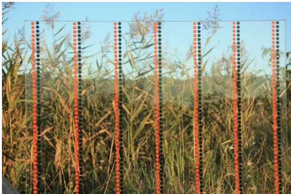
Abbildung 11: „Punkte schwarz-orange“ wurde im ONR-Versuch von nur 2,4% der Vögel angefliegen und war daher als Referenzscheibe für „Lärmschutzwand“- und „Fenster-Versuch“ gut geeignet. Es wurde sowohl der Fall mit Bedruckung auf der
