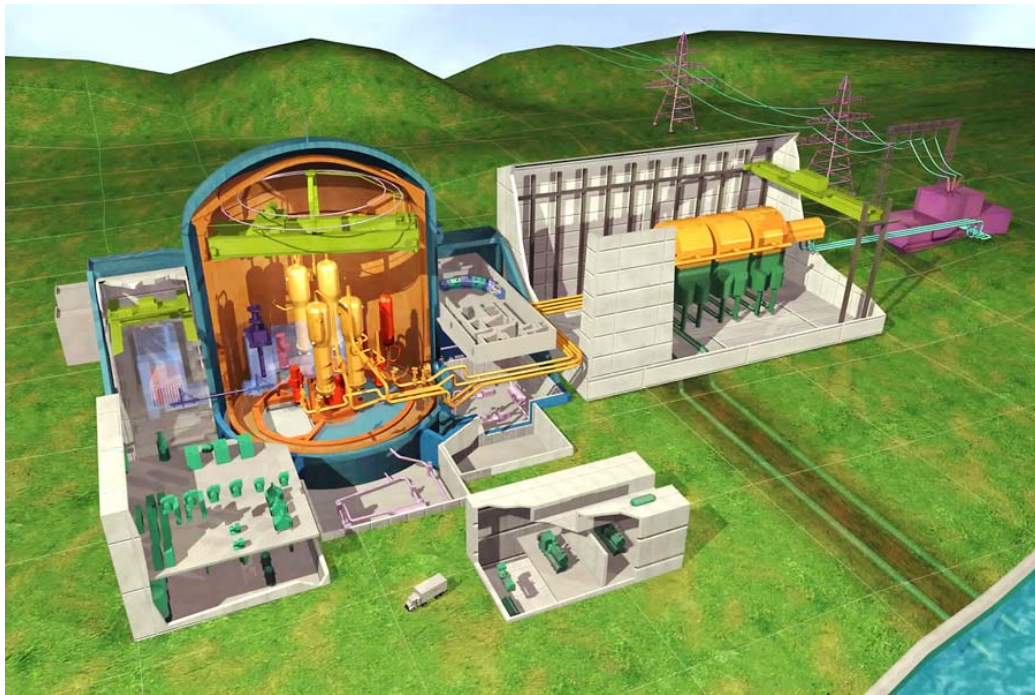
Abbildung 25...EPR: Beispiel das in Bau befindliche AKW in Flamanville (F)
